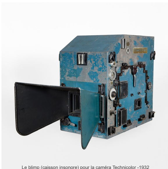
Le blimp (caisson insonore) pour la caméra Technicolor -1932
