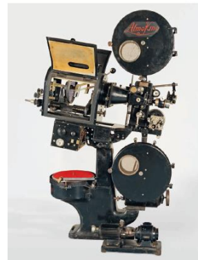
Projecteur 35 mm sonore, équipé d'un lecteur de disque type Vitaphone et d'un lecteur de son optique type Movietone, Rotterdam, c. 1929.
